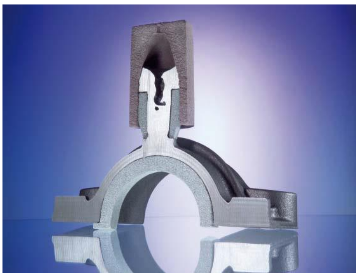
Figura 4: Molde con tele-alimentador y anillo exotérmico (interno)
